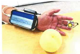
指先のセンサーで桃の熟度を判定する装置。結果はスマートフォンに表示される
